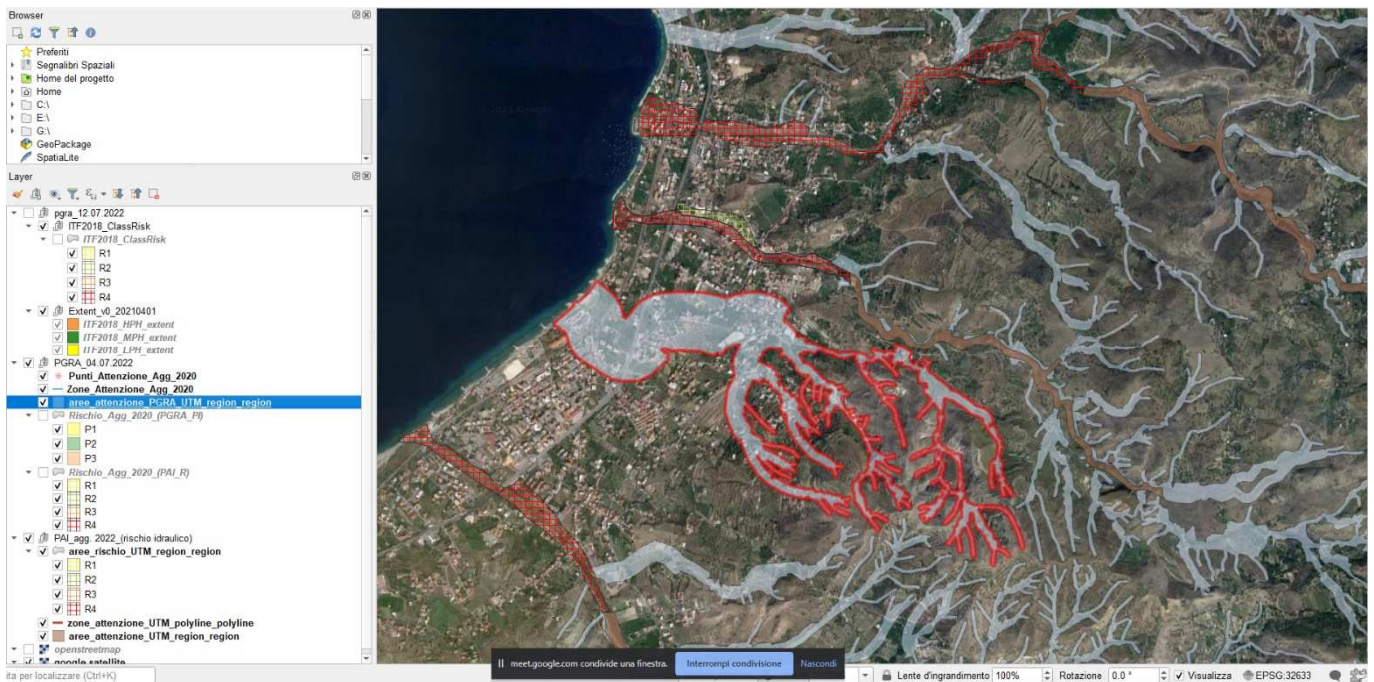
PGRA – Zona Pèllaro. Esempio di dimensionamento eccessivo delle aree di attenzione, rispetto al bacino sotteso. Inoltre, emerge un'articolazione esasperata del reticolo idrografico rispetto alla scala cartografica.
