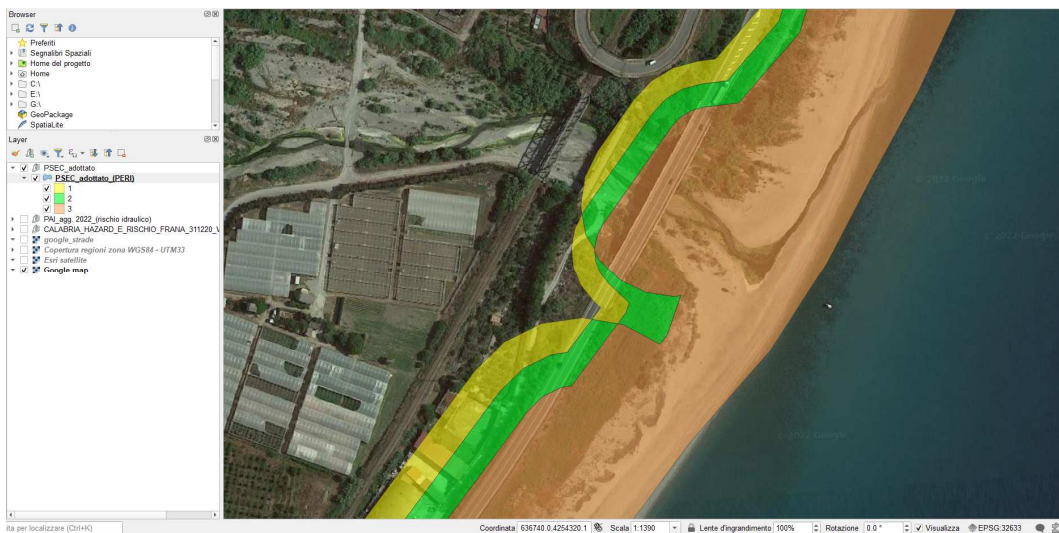
VL – PSEC ( PSEC_adottato - shapefile.zip ): pericolosità da erosione costiera (campo: PERI). Monasterace. Zonazione discontinua. Incongruenza con foce fiumara.
