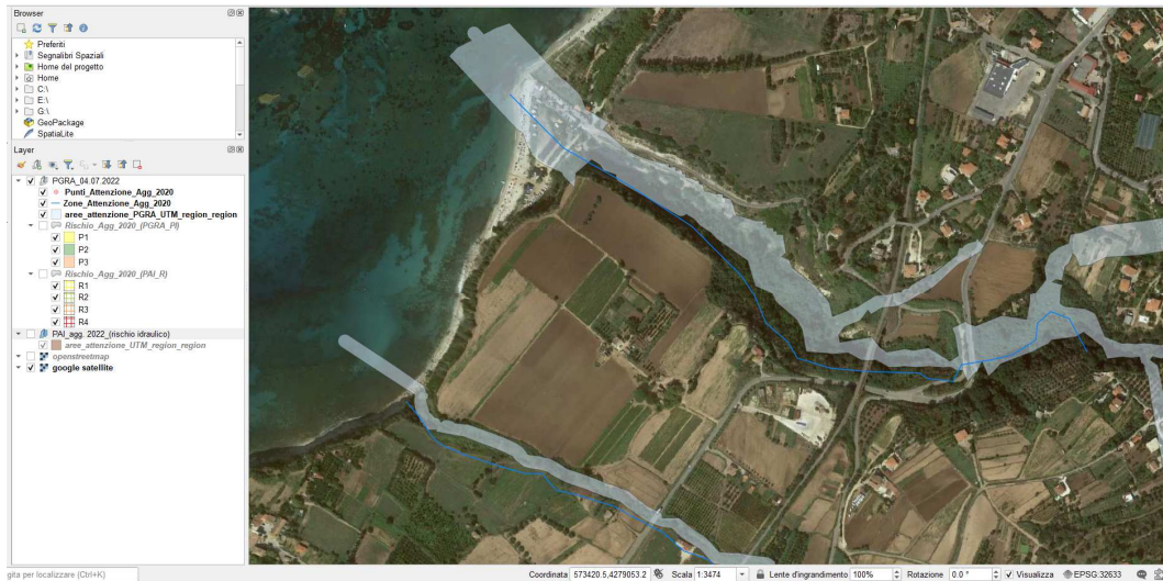
VL - PGRA – rischio.zip & PAI_agg. 2022.zip: S. Domenica Ricadi – Layers: Punti_Attenzione_Agg_2020.shp + Zone_Attenzione_Agg_2020.shp + aree_attenzione_PGRA_UTM_region_region.shp. Zone di attenzione PGRA fuori alveo, e aree di attenzione PGRA oltre la linea di costa.
